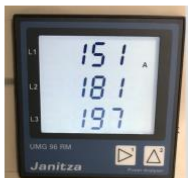
Bild 2. Janitza logger visar Amper per fas
